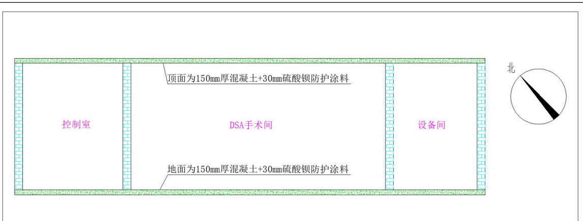
图 10-2 机房防护设计方案（立面）
